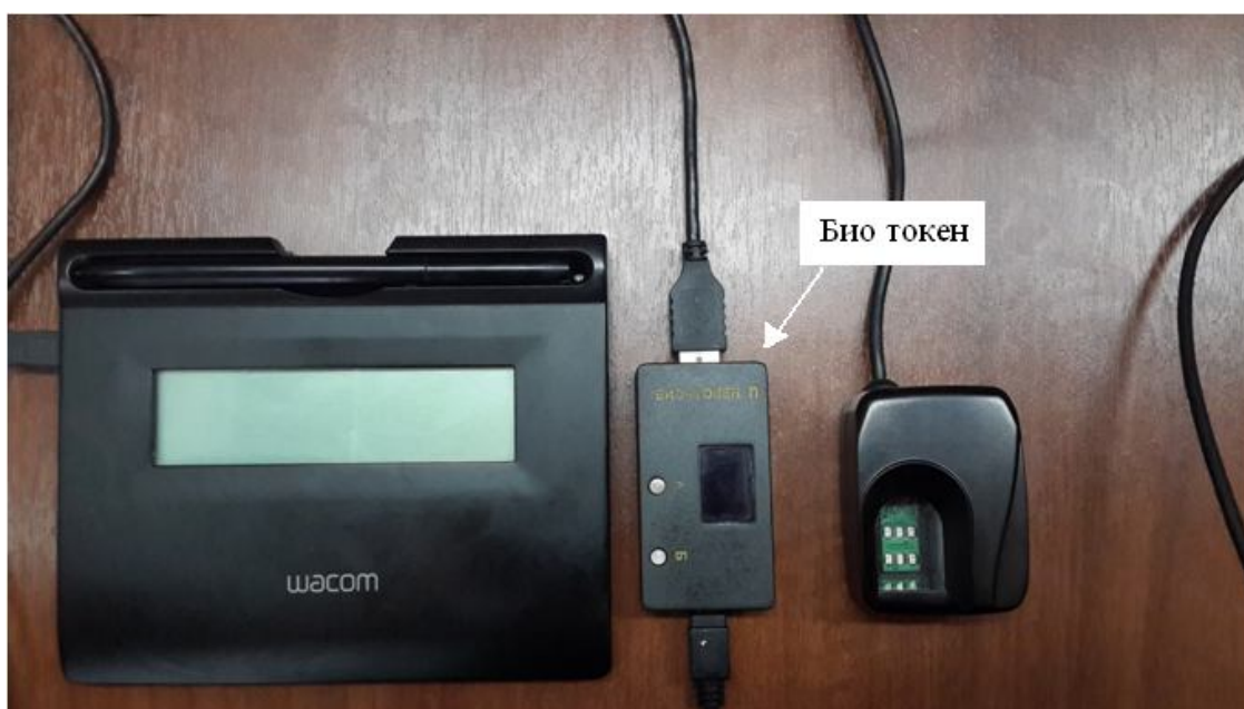
Рис. 2. Внешний вид доверенной вычислительной среды «БиоТокен», выполненной в виде USB переходника между сканером биометрии и вычислительной машиной, подключенной в корпоративную сеть предприятия, через ПО средства «БиоПортал»
